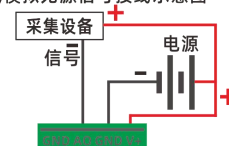
(2)模拟无源信号接线示意图
