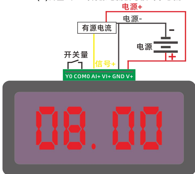
(1)测量3、4线有源电流信号接线示意图
