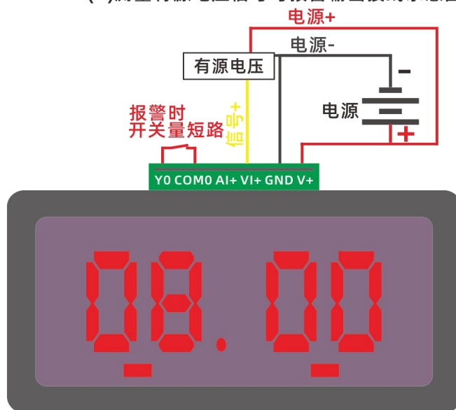
(4)测量有源电压信号与报警输出接线示意图
