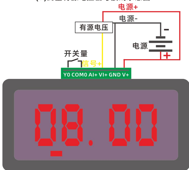
(3)测量有源电压信号接线示意图
