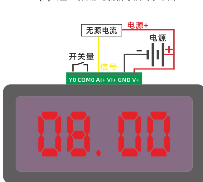
(2)测量2线无源电流信号接线示意图
